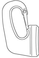
AnschweiÑhaken nach dieser THIELE-Werksnorm (TWN) sind zum Heben und Bewegen von Lasten vorgesehen und werden vornehmlich an Erdbaumaschinen, z.B. an Schaufeln, angeschweiÑt. Sie werden fest mit dem tragenden Bauteil durch SchweiÑen verbunden.
