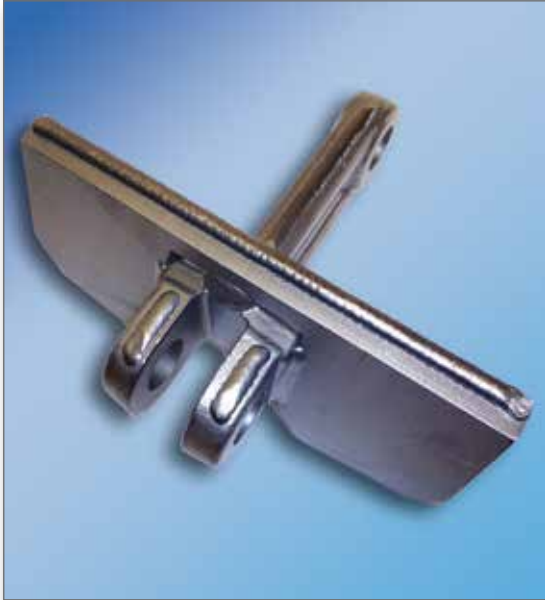
Твердосплавные накладки на особо ответственных местах
