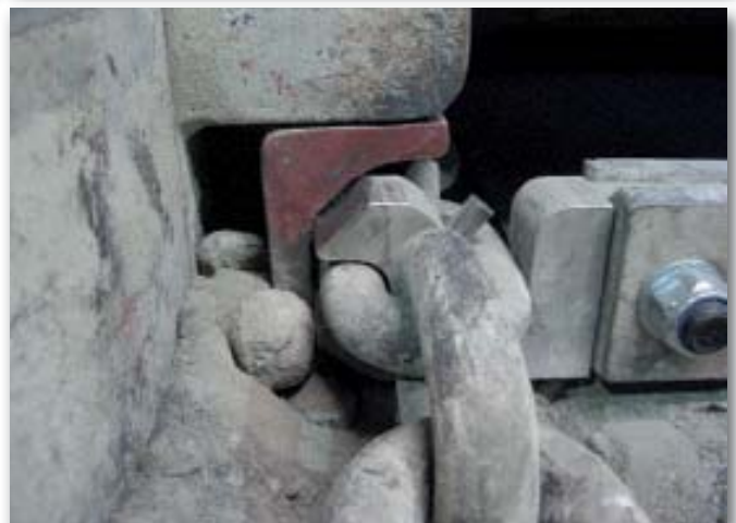
Univerzalni nosači grabulje koji omogućuju ponovno korištenje postojećih grabulja i upotrebu u dugostrukim lancima
