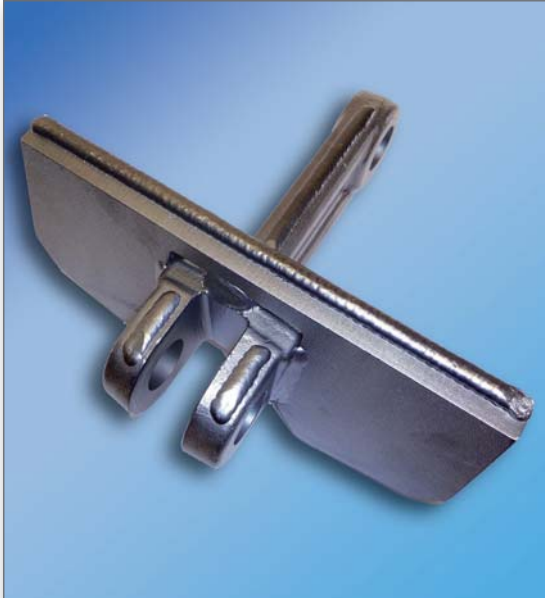
Nanošenje vara tvrdom elektrodom najčešće povećava životni vijek na najzahtjevnijim mjestima lanca
