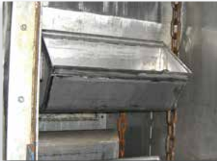
Standzeitoptimierung durch Einsatz von Rundstahlkette Typ THIELE E-PRO 805.
