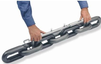
Alternativ können geeignete Kettenstücke (7 Glieder, keine Passketten) THIELE zur Prüfung zugesandt werden.
