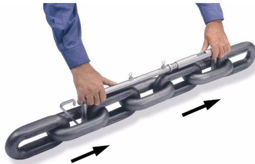
Ergänzend zu Messungen mit der Kettenmesslehre können auch geeignete Kettenstücke (7 Glieder, keine Passketten) zur Prüfung an THIELE gesendet werden. Bei den Prüfstücken ist sicherzustellen, dass die Proben die gleiche Laufzeit wie die übrige Kette aufweisen.
