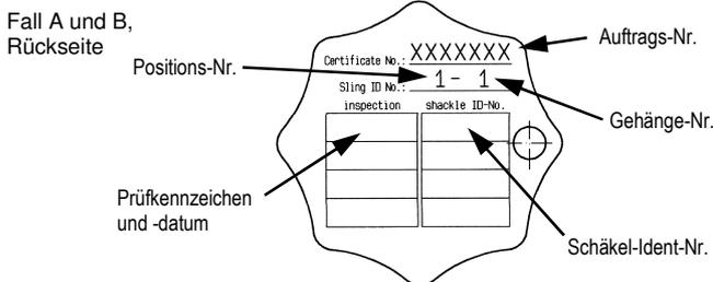
Das Aufhängeglied ist zusätzlich mit der DNV-Abnahmenummer oder der Auftragsnummer zusammen mit der Positionsnummer und der jeweiligen Gehängenummer gekennzeichnet.
