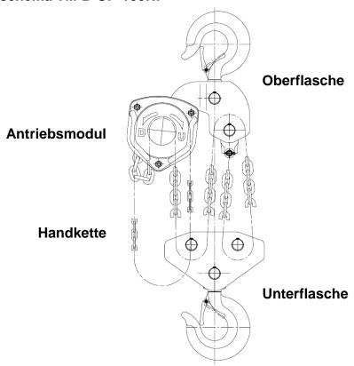
Bei der Kettenmontage ist darauf zu achten, dass die Schweißnähte der stehenden Kettenglieder in den Kettenrädern von Antriebsmodul und Oberflasche nach außen zeigen!
