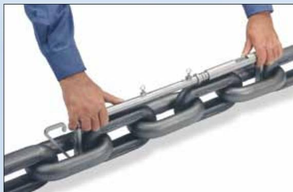
Während die Messschenkel fest an den Rundungen der Kettenglieder anliegen wird der Messwert auf der Millimeterskala an der Markierung abgelesen.
