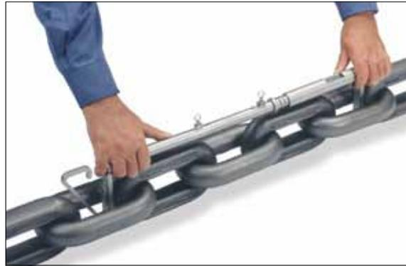
Alternativ können geeignete Kettenstücke (7 Glieder, keine Passketten) THIELE zur Prüfung zugesandt werden. Bei Prüfstücken ist sicherzustellen, dass die Proben die gleiche Laufzeit wie die übrige Kette aufweisen.
