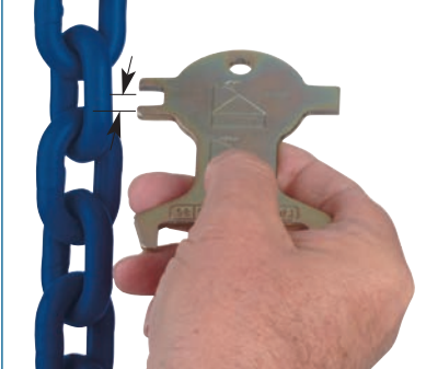
Prüfung des Materialdurchmessers
