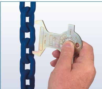
Prüfung der bleibenden Dehnung
