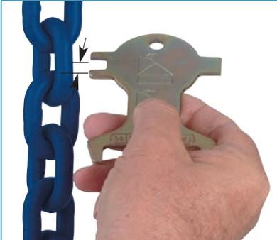
Prüfung des Materialdurchmessers
