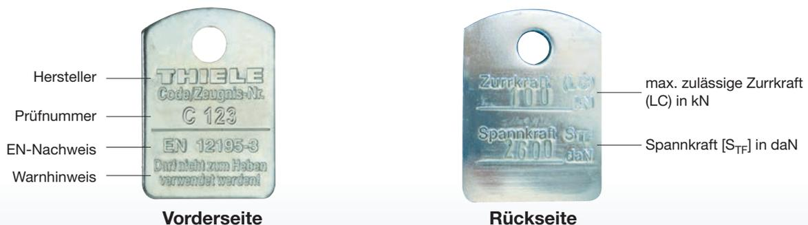
Die Anhänger nach DIN EN 12195-3 geben auf der Vorderseite neben der Norm den Kettenhersteller, die Prüfnummer der Herstellerprüfung sowie den Warnhinweis, die Kette nicht zum Heben zu verwenden, an. Auf der Rückseite sind die maximal zulässige Zurkraft (LC) in kN sowie die maximale, normale Spannkraft  $[S_{TF}]$  in daN eingeschlagen.
