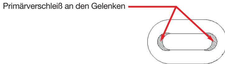
Daher werden THIELE-Förderketten mit einer entsprechenden Oberflächenhärte und Einsatzhärte tiefe versehen. Dem betriebsbedingten Verschleiß wird somit entgegengewirkt.
