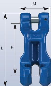
Die **Verkürzungsklaue mit Gabel TWN 1851** ist aus dem Güteklasse 8 - Programm in die Güteklasse 10 weiter entwickelt worden. Die Gabel ist verwechslungsfrei auf die jeweilige Nenngröße konstruiert. Die Kette hat einen sicheren Halt in der Klauentasche, so dass diese zu keiner Zeit herausfallen kann.
