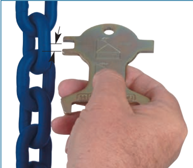
Prüfung des Materialdurchmessers
