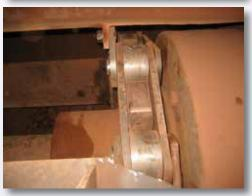
链斗式堆取料机装配加固型板式链条, 用于低温环境下固化散料的输送。
