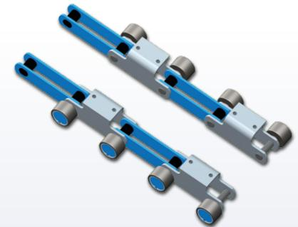
蒂勒HDR-BO型链条的箱型联接板由外链板弯曲焊接而成。蒂勒链条的强化型设计,可以平稳抗衡实际工作过程中的频繁外力波动以及载荷峰值。
