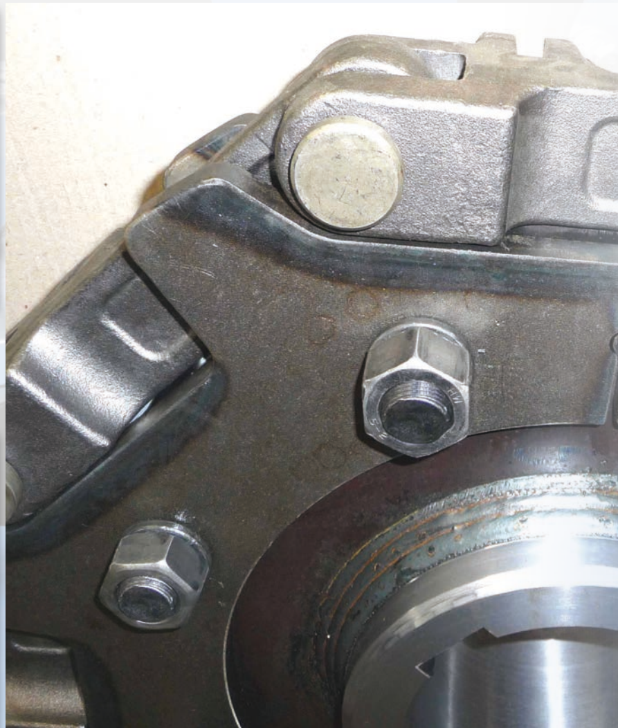
Specjalnie utwardzane bieżnie i boki zębów zapewniają optymalną żywotność
