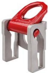
Die anschweißbaren ZK-Module TWN 1471 werden vorwiegend in C-förmigen Seitenrahmen von Tiefladern verbaut. Durch den großen Schwenkbereich können auch überstehende Lasten sicher verzurrt werden. Eine neu entwickelte, patentierte Kulissenform der Kassette ermöglicht eine Montagestellung zur einfachen Anbindung der Zurrmittel. Stressless Lashing® in Perfektion.
