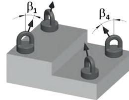
2. Bestimmen Sie die Anzahl der erforderlichen Anschlagpunkte in Abhängigkeit der Strangzahl des Kettengehänges und der verfügbaren Einbaulage (siehe Piktogramme auf den Seiten 104-107 und 112-113).
