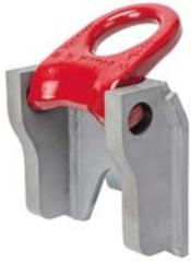
Die anschweißbaren ZKS-Module TWN 1477 werden vorwiegend in Seitenrahmen von Tiefladern verbaut. Durch den großen Schwenkbereich können auch überstehende Lasten sicher verzurrt werden. Die in der Kassette eingebaute große schwenkbare Zurröse ermöglicht eine Montagestellung zur einfachen Anbindung der Zurrmittel.
