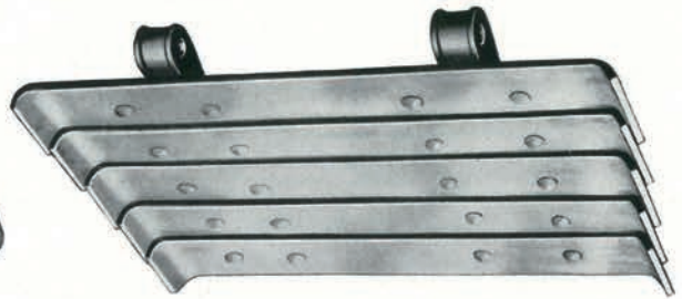
Teil einer aus Stahlplatten zusammengebauten Bandmatte (Draufsicht)
