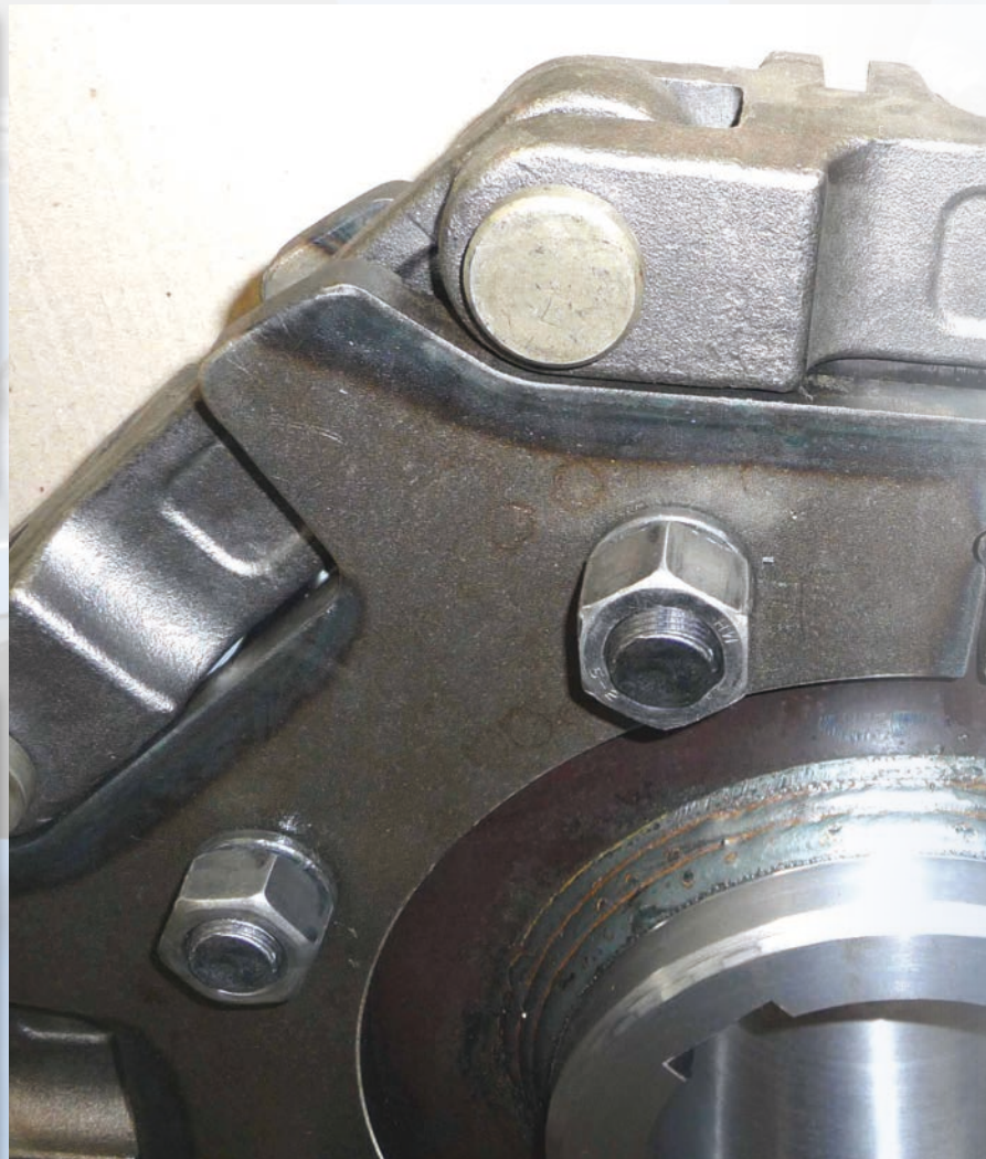
Speziell gehärtete Lauflächen und Zahnflanken sorgen für optimale Standzeiten
