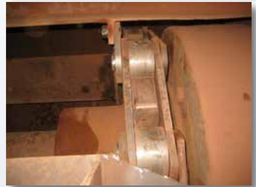
Rollenkette in verstärkter Ausführung für Eimerkettenbagger zum Ausspeichern von verfestigtem Schüttgut bei tiefen Temperaturen.
